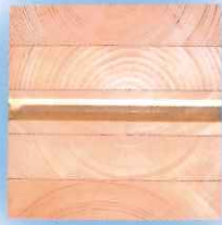
通柱と胴差加工 通柱と金具取付用ボルト穴 (米松集成材 120×120)
